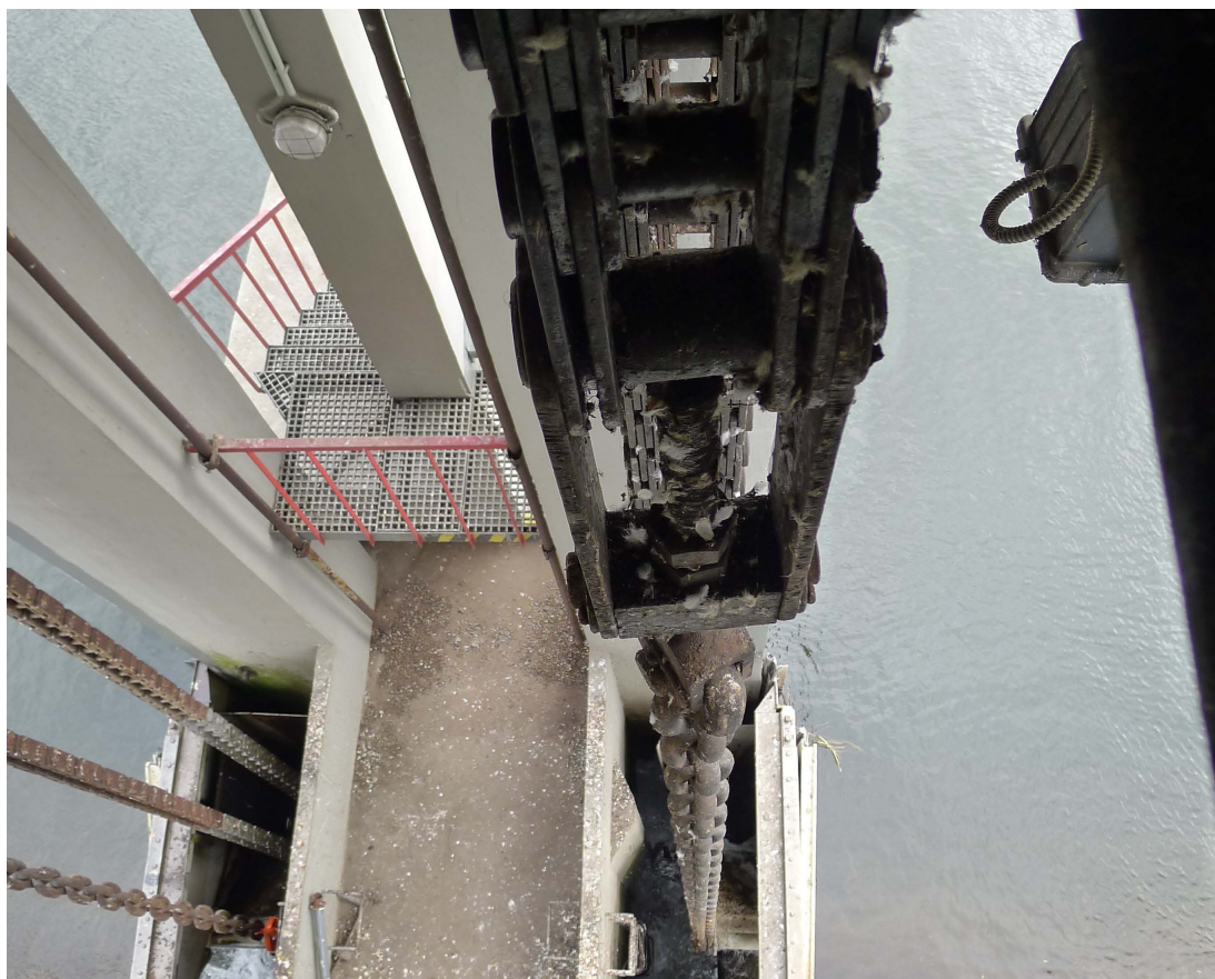
Regulační napínák horního závěsu článkového řetězu
