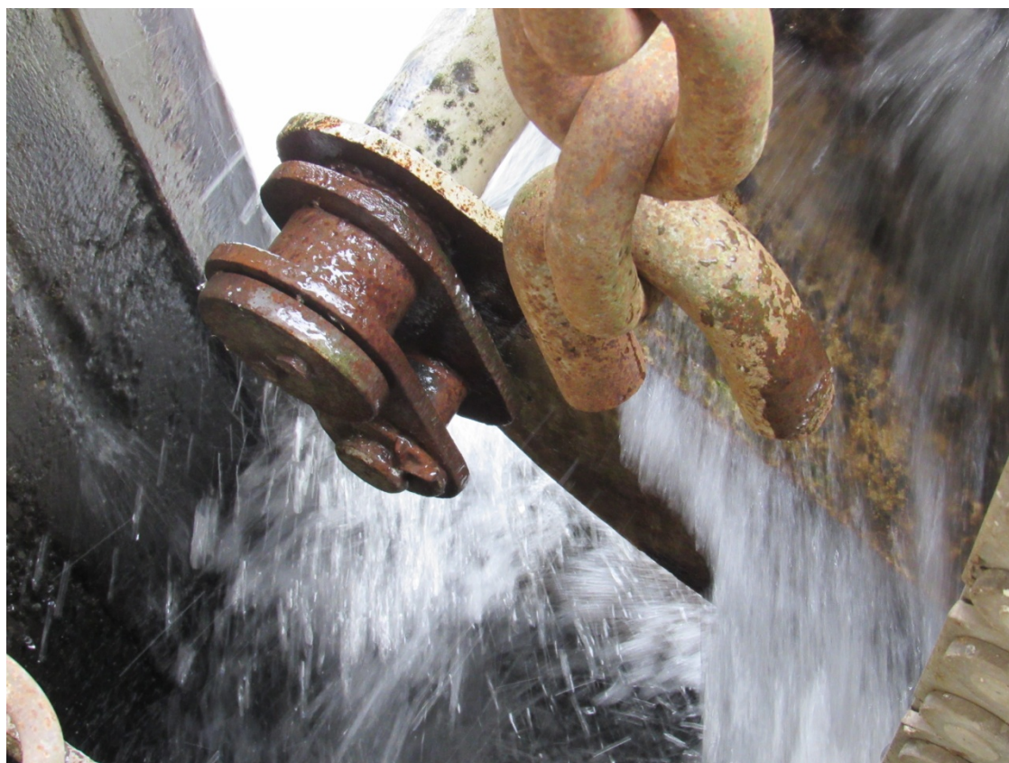
Dolní závěs článkového řetězu – přetržené koncové oko
